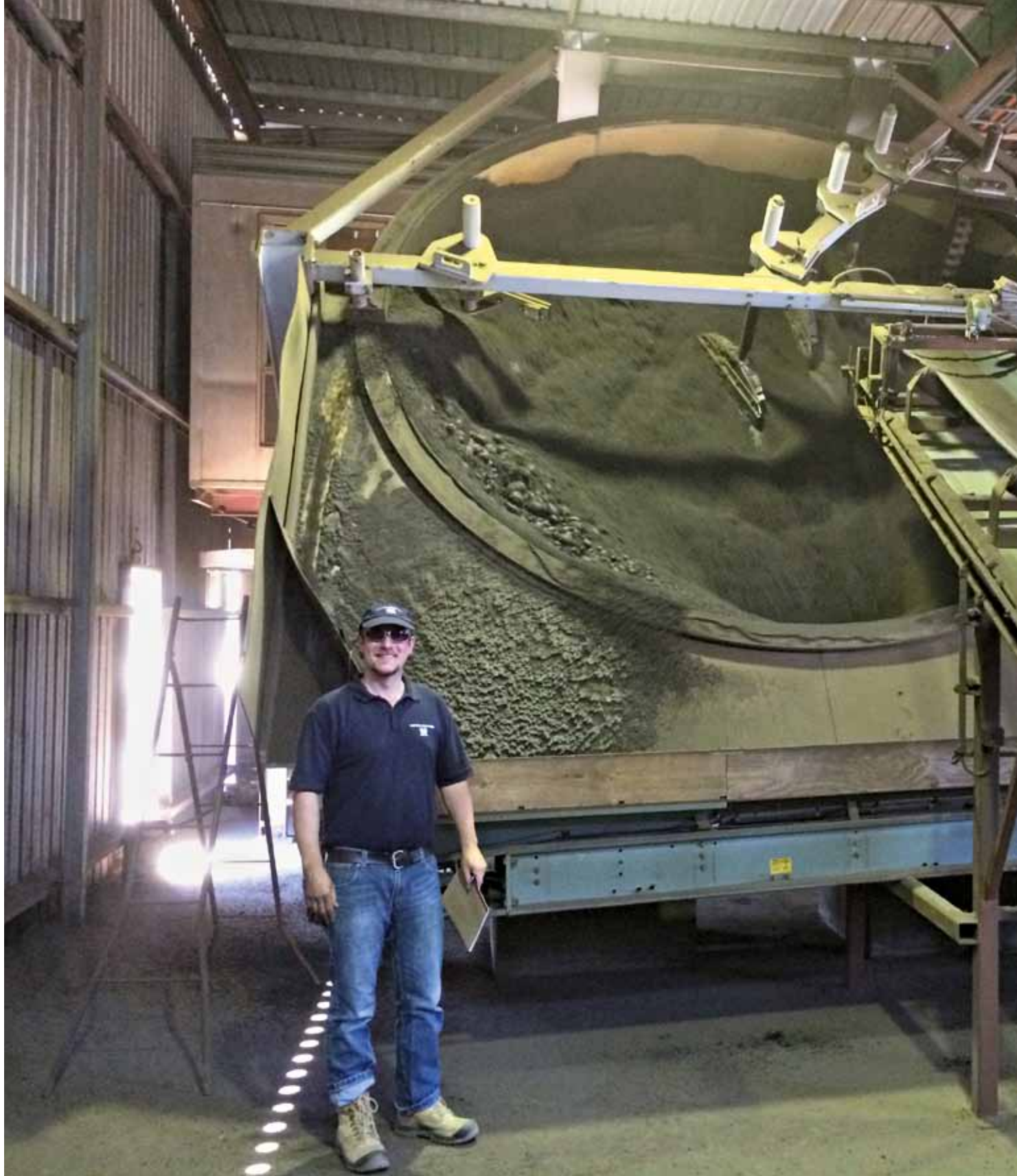
5 Granulierteller HAVER SCARABAEUS SC4200 während der Inbetriebnahme • HAVER SCARABAEUS SC4200 disc granulator during the commissioning
