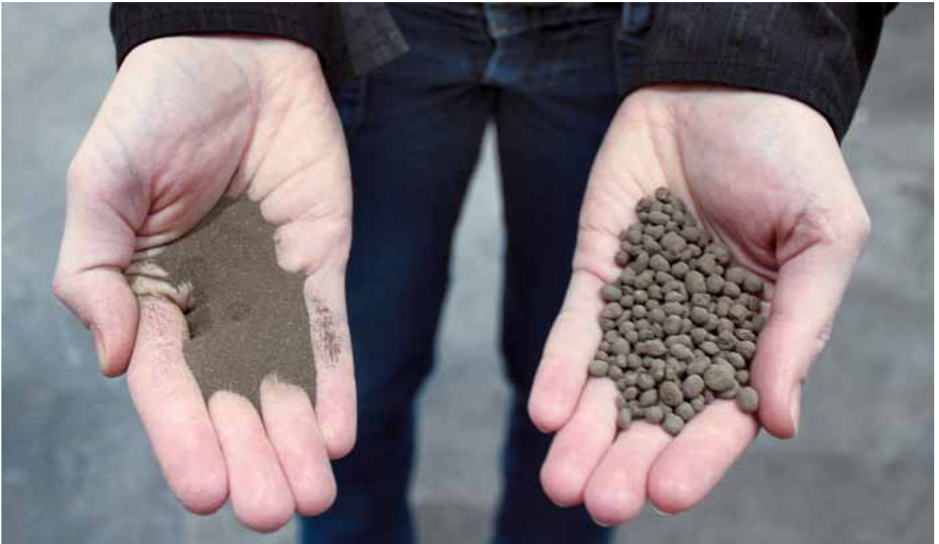
Aufgabematerial (links) und Düngemittelgranulat (rechts) • Feed material (left) and fertiliser granulate (right)
